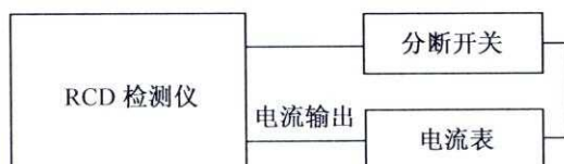
图 2 离线检测型 RCD 检测仪校准
