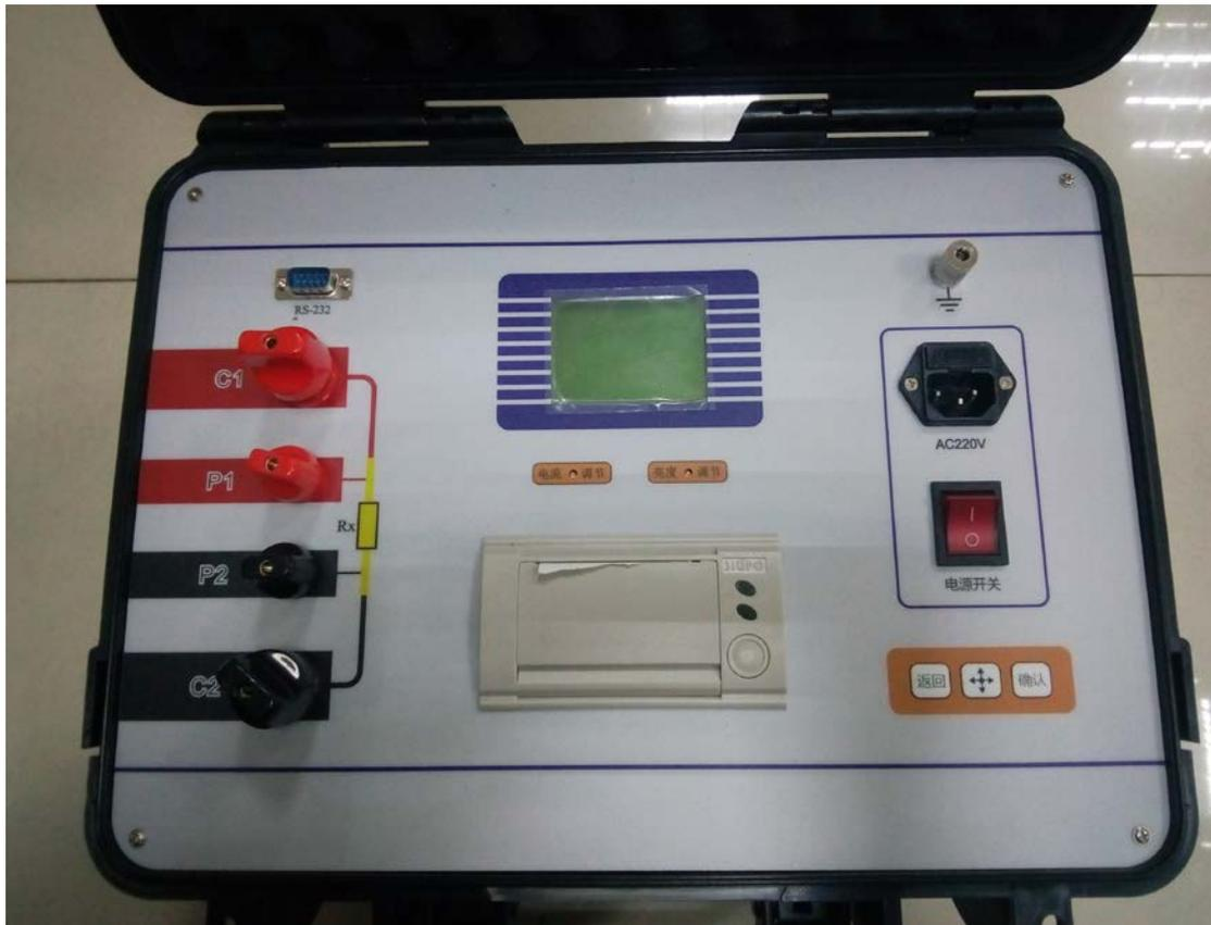
图 1 回路电阻测试仪
