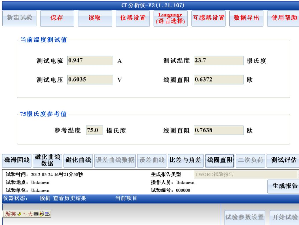
图 5.6 线圈电阻实测参数界面
