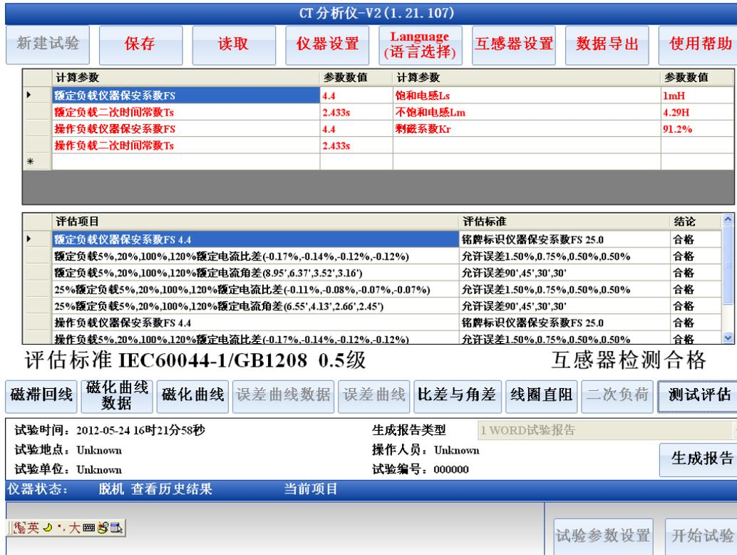
图 5.7 励磁参数和测试评估界面
