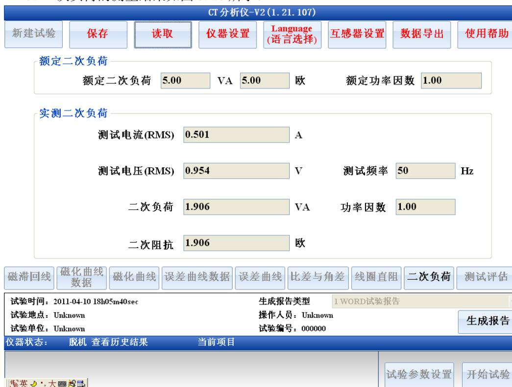
图 5.10 二次负荷测量试验结果
